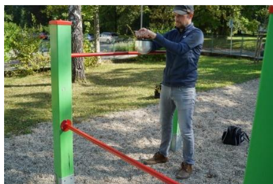
Měření mechanických vlastností dopadových ploch
